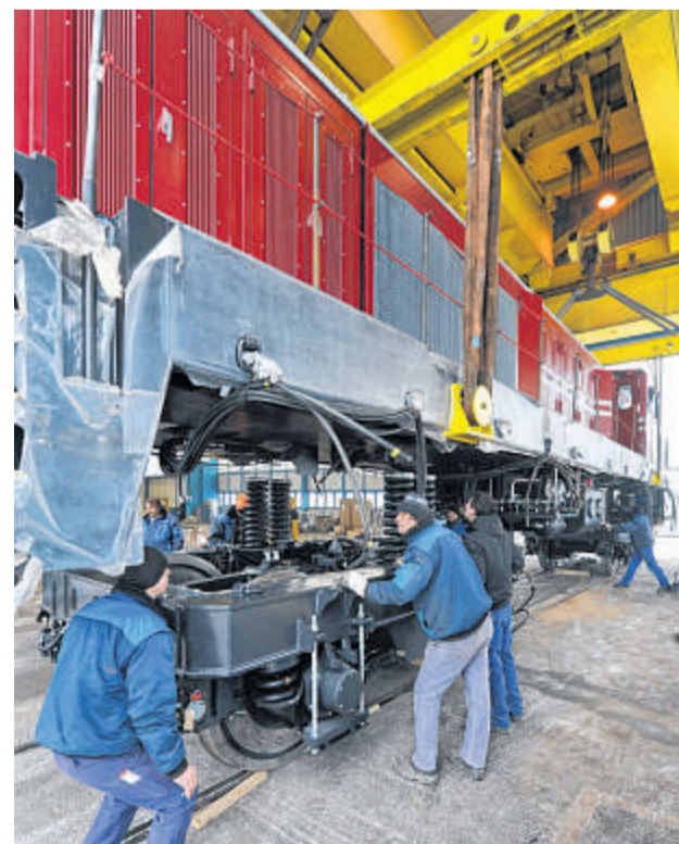
Hochzeit: Am Rahmen ist die Kranaufhängung befestigt. Das Chassis wird passgenau auf die beiden Drehgestelle gesetzt.
