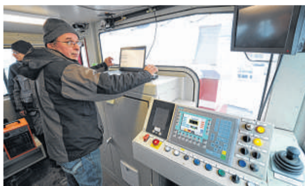
Solide Technik ohne Schnickschnack: Zwei Steuerstände hat die Lok, in der Praxis läuft sie später per Fernbedienung.
